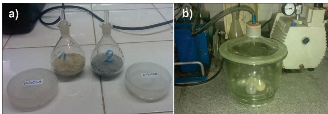
**Figura 12:** a) picnómetros utilizados para la determinación de la densidad de los sedimentos b) desecador acoplado a una bomba de vacío.
