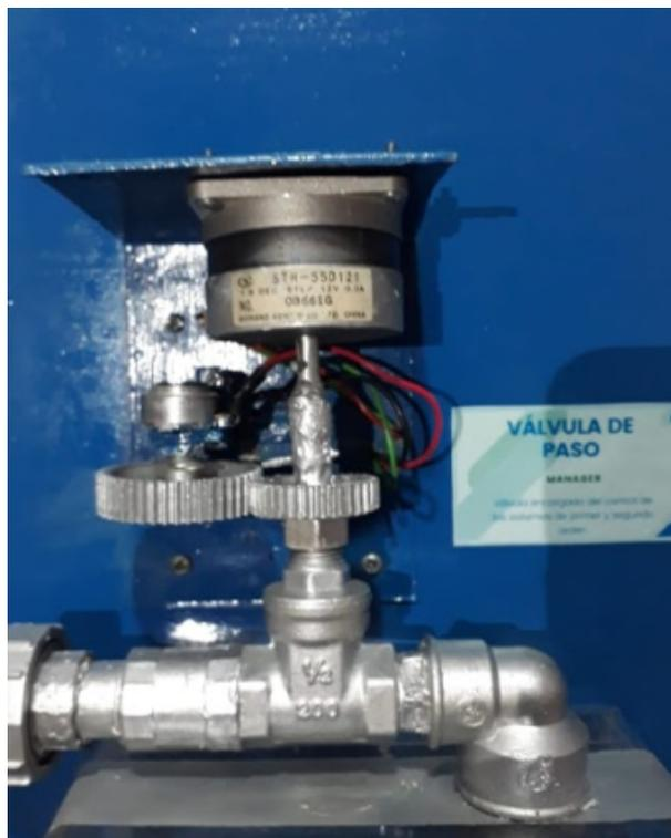
Figura 4.20: Eje del motor acoplado a válvula. [32]
