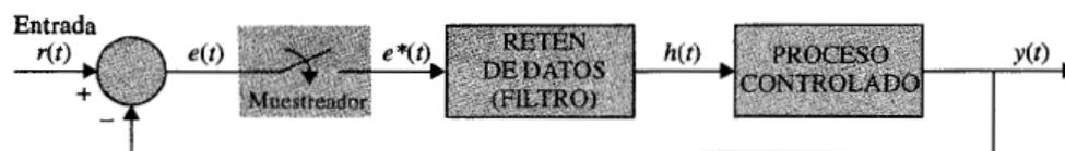
Figura 3.12: Diagrama de bloques de un sistema de control de datos muestreados. [15]
