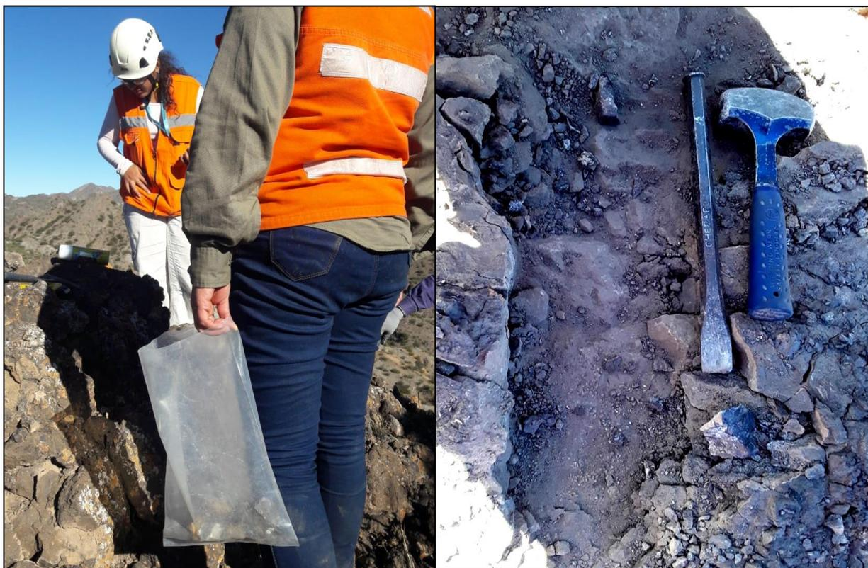
Figura 11. Muestreo sistemático de la veta.
