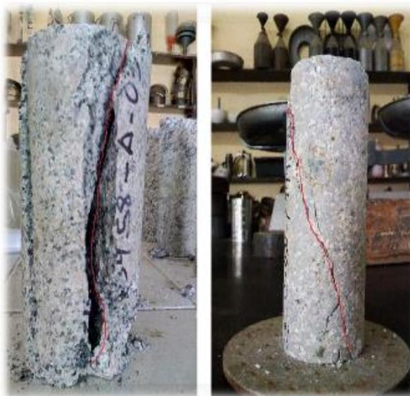
Imagen 25: modo de ruptura del granito fresco con fractura rugosa ondulada (izquierda) y granito alterado con fractura ondulada levemente rugosa (derecha).
