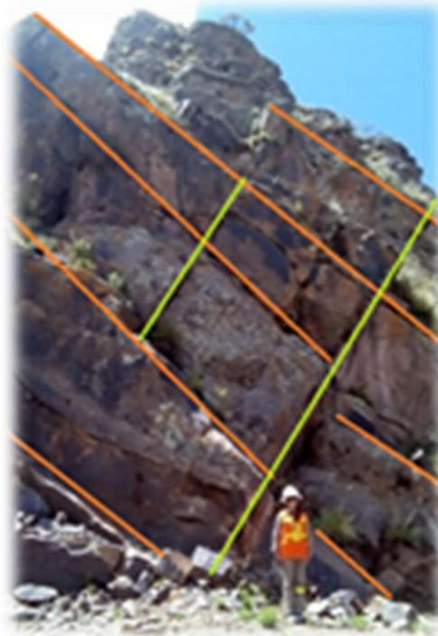
Imagen 8: El macizo presenta un modo de fracturamiento en masivo y bloques (MP1)
