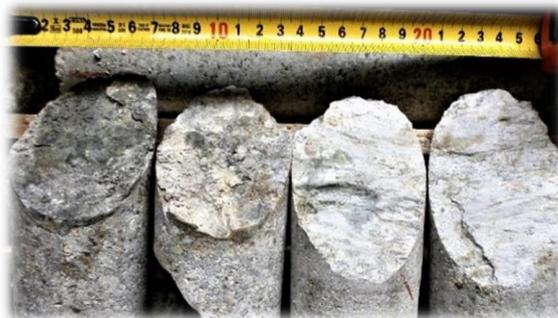
Imagen 14 Planos de cizalla, rellenos duros de calcita y MnO.
