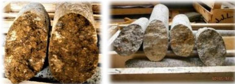
Imagen 13: Superficies onduladas rugosa con óxidos ocre (izquierda) y rugosas onduladas con patinas de óxidos (derecha).
