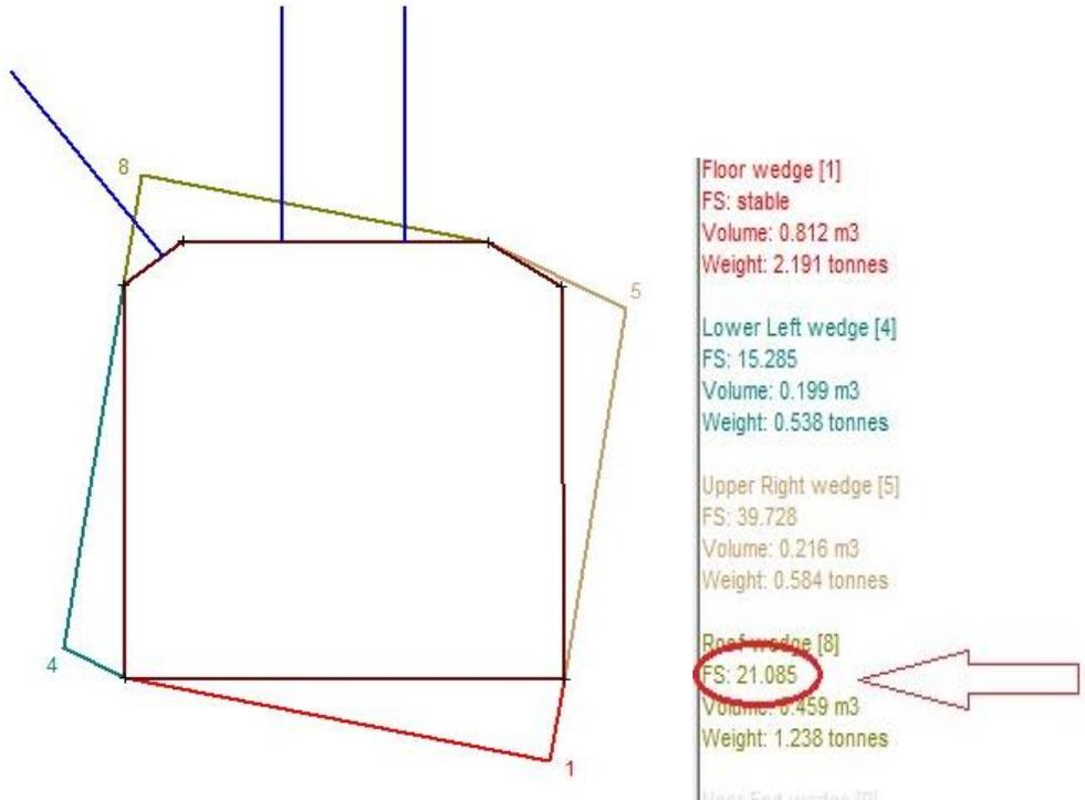
Figura 36. perfil de la sección estudiada, se colocaron 3 cables bolt de 2 m de longitud, con un patrón de empinado de 1 m.
