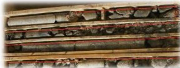
Imagen 2: Longitud de roca fracturada, zona de falla.
