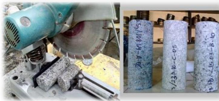
Imagen 5: izquierda sierra sensitiva; derecha probetas ya cortadas
