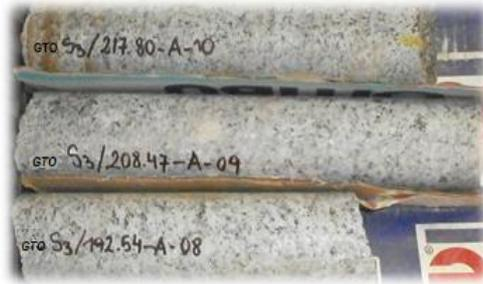
Imagen 4: Muestras seleccionadas para ensayo de compresión uniaxial.
