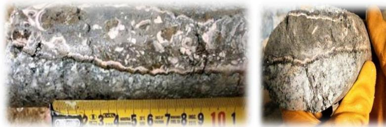
Imagen 16: Contacto del Granito (roca de caja) con la veta Ortiz (textura brechada).
