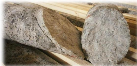
Imagen 18: Fracturas naturales, a la izquierda con relleno arcilloso.
