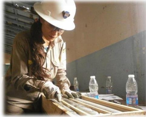
Imagen 3 Prueba de dureza en testigos empleando la navaja
