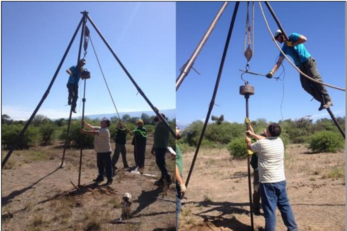
**Foto 3:** Ejecución del Ensayo de Penetración Estándar (S.P.T.).
