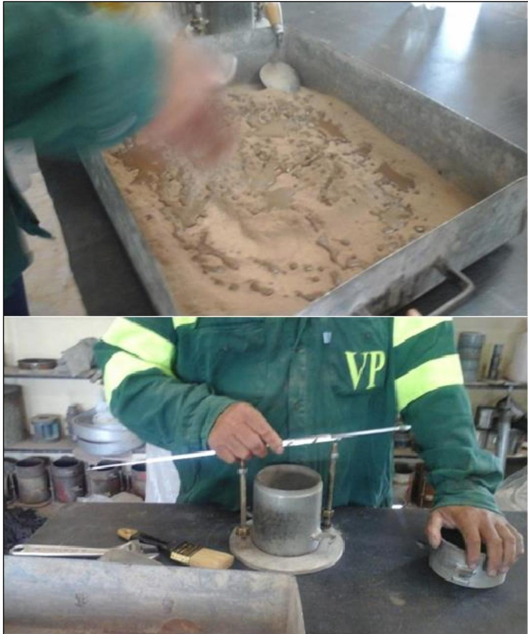
**Foto 13:** a) Preparación de la muestra; b) Verificación de las constantes del molde.
