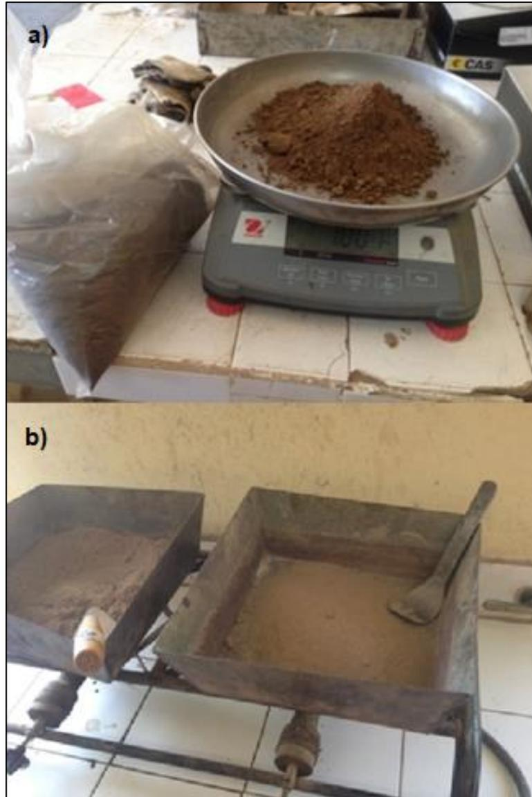
*Foto 7: a) pesaje de muestra humedad; b) secado de muestra en estufa.*
