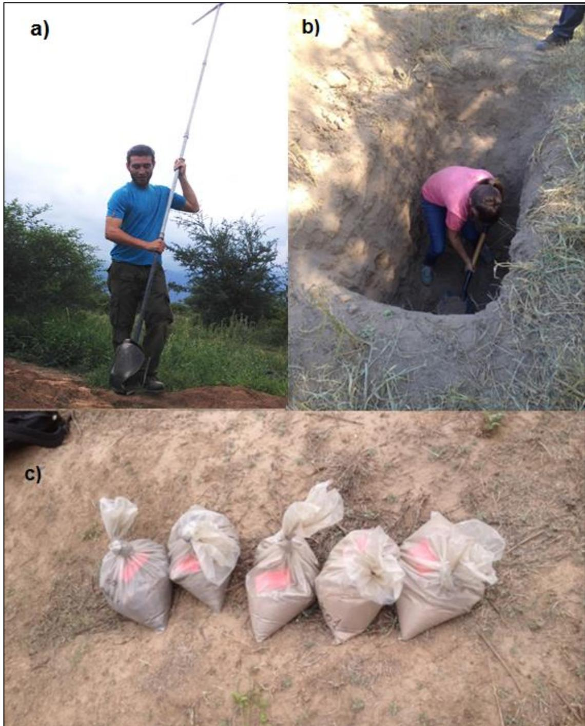
*Foto 2: a) Ejecución de sondeo con pala vizcachera; b) Excavación de calicata; c) Bolsas de muestra rotuladas.*
