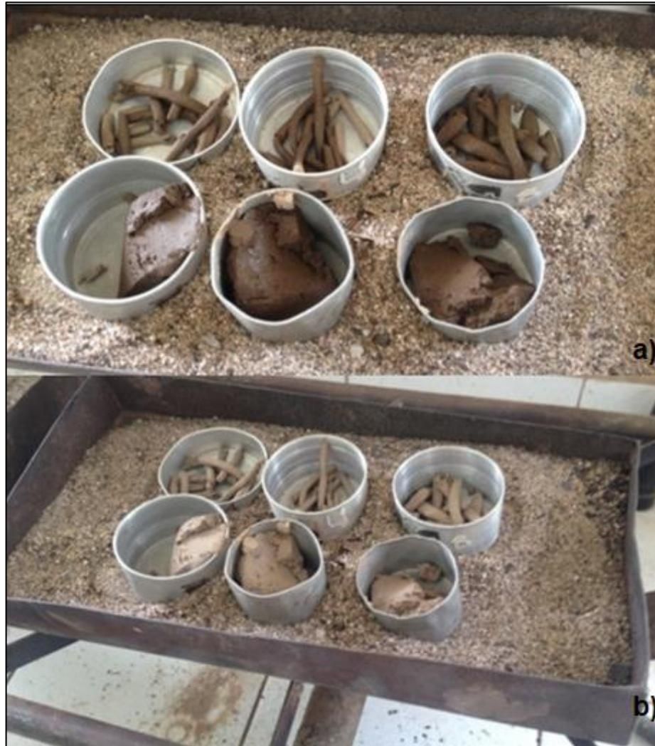
Foto 12: Pesafiltros con muestras a) húmedas; b) secas.
