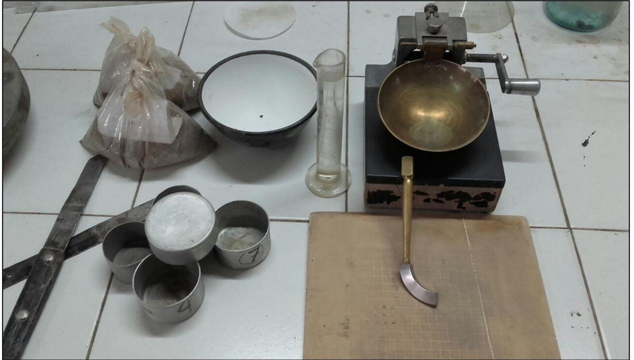
*Foto 10: Instrumental de trabajo: cápsula de porcelana, espátula, cuchara de Casagrande, probeta, superficie de amasado, pesafiltros.*
