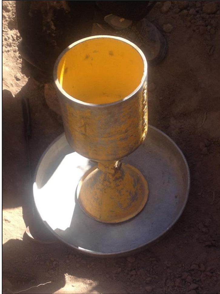
*Foto 5: Aparato Cono de Arena para el ensayo de las densidades.*
