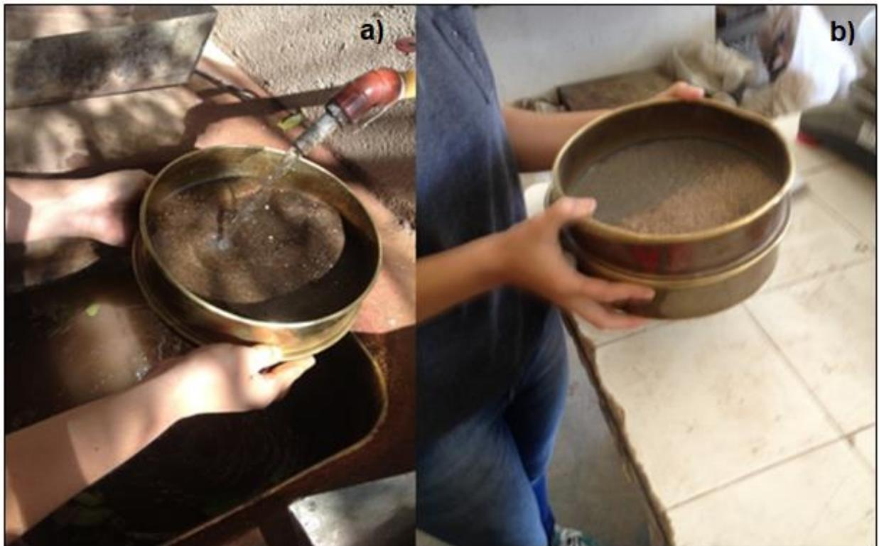
Foto 9: a) Tamizado vía húmeda; b) Tamizado vía seca.
