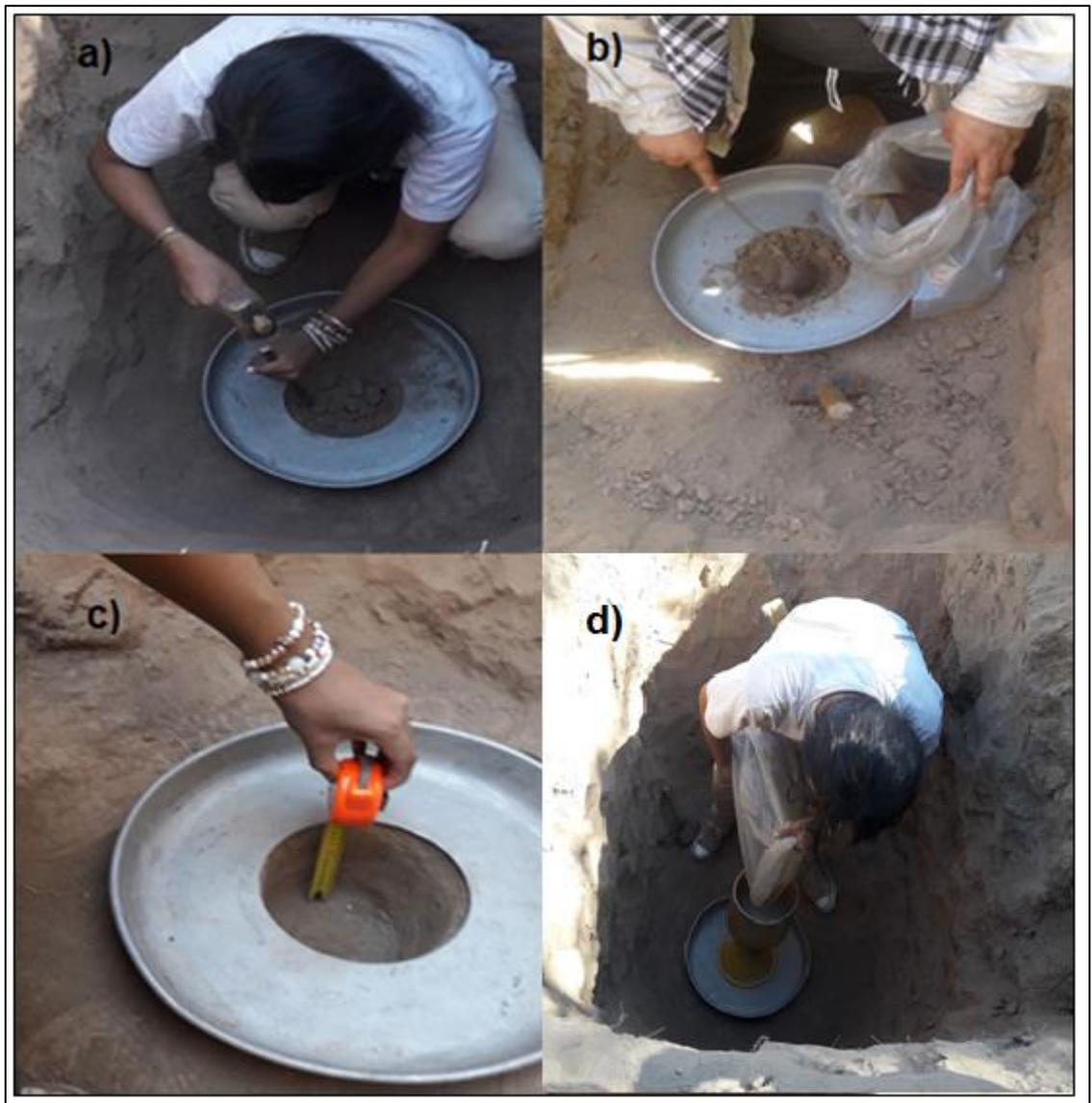
**Foto 6:** a y b) Realización del pozo y extracción de muestra; c) Medición de profundidad del pozo; d) Llenado del cono con arena calibrada.
