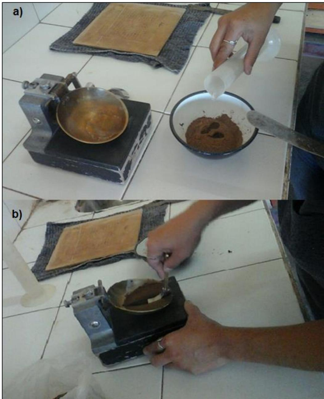
**Foto 11:** a) Preparación de muestra; b) Acanalado de la muestra en la cápsula de Casagrande.
