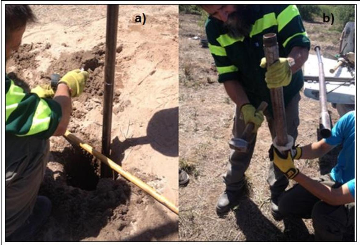
**Foto 4:** a) Demarcación de los 30 cm a hincar; b) Extracción de muestra del portatestigo.
