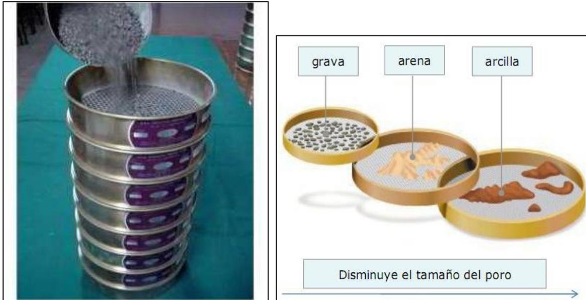
**Figura 12:** Juego de tamices de mayor a menor diámetro (izquierda), se separan fracciones de grava, arena y arcilla que constituyen una porción de suelo (derecha). Fuente: <http://www.fullquimica.com/2011/08/tamizado.html>
