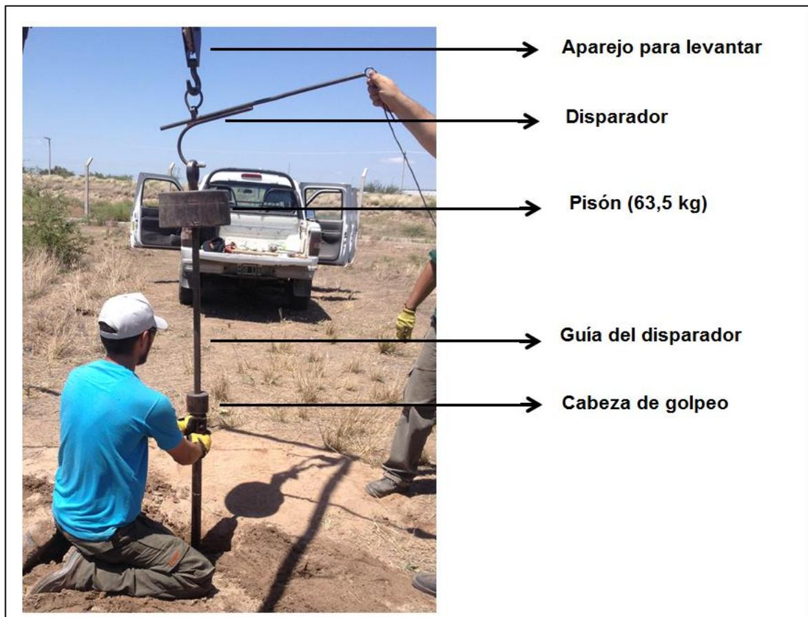
**Figura 38:** Partes del dispositivo Terzaghi. Trabajo In Situ.
