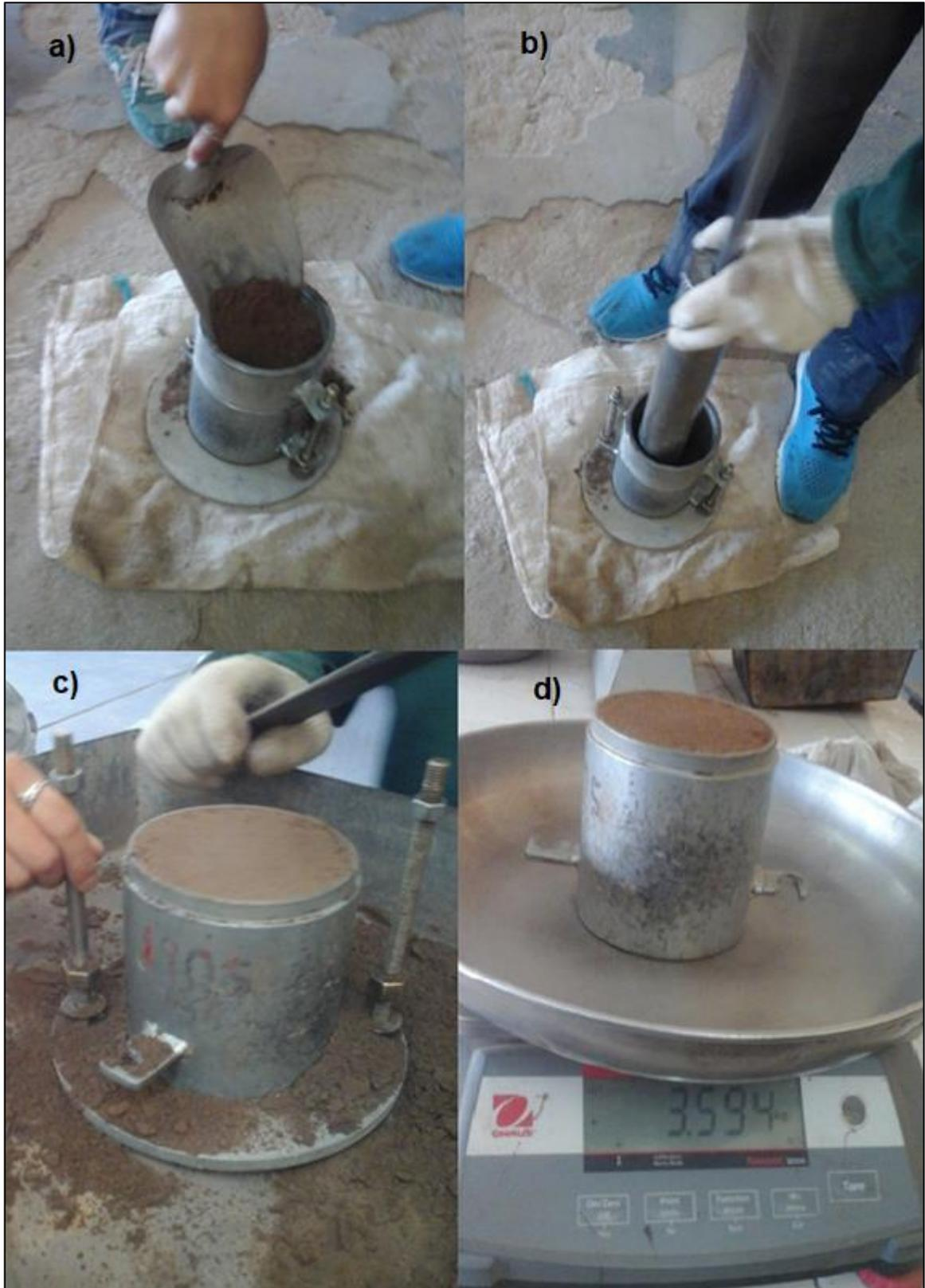
**Foto 14:** a y b) Llenado y compactación de la muestra con el pisón; c y d) Enrasado y pesaje.
