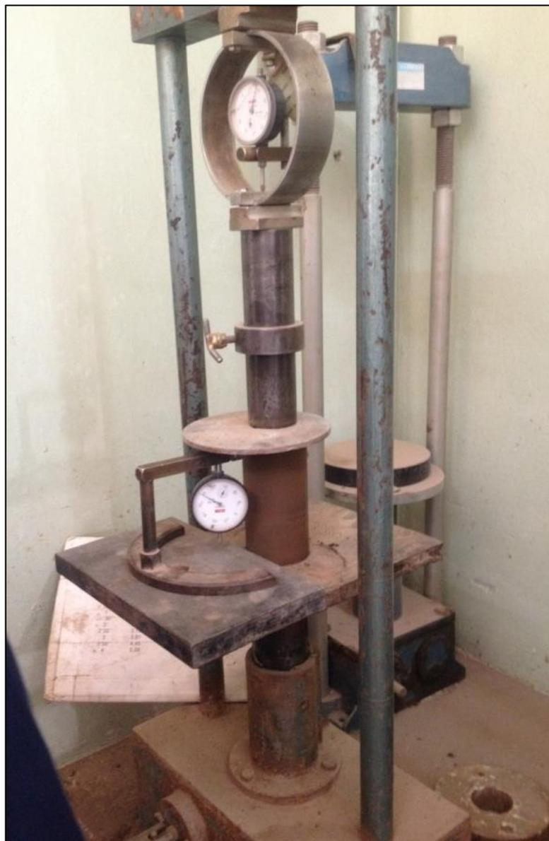
*Foto 18: Prensa hidráulica con la probeta de suelo a ensayar.*
