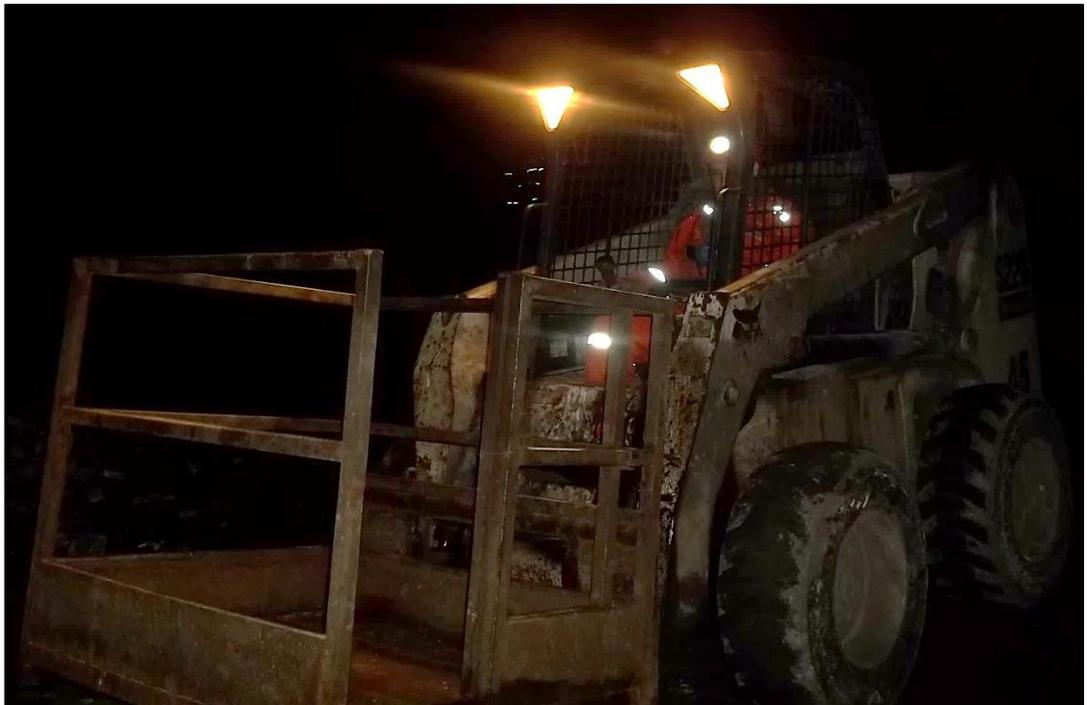
**Imagen 48:** minicargadora utilizada para cargar explosivos en topes y frentes - Prueba N° 9
