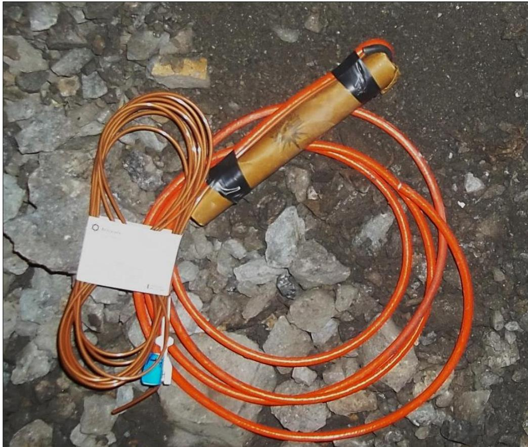
**Imagen 44:** armado del cebo con un cordón detonante de gramaje 40 - Prueba N° 8
