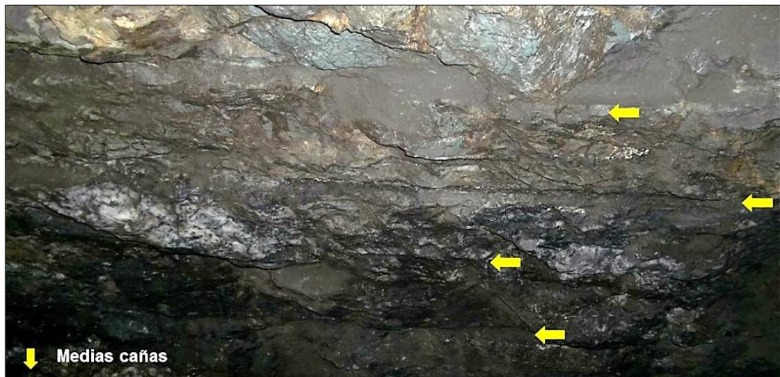
**Imagen 25:** Superficie de precorte – Prueba N° 9
