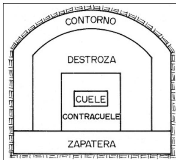
Figura 5: Zonas de una voladura a Sección Completa
