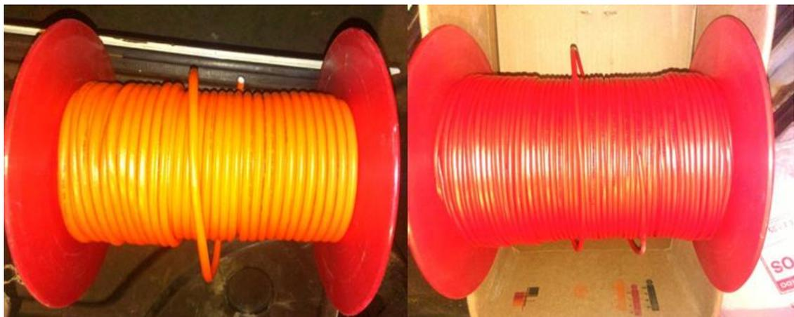
**Imagen 4:** Accesorio de voladura – Cordón detonante de 40 y 5 gr/m (Austin Powder)
