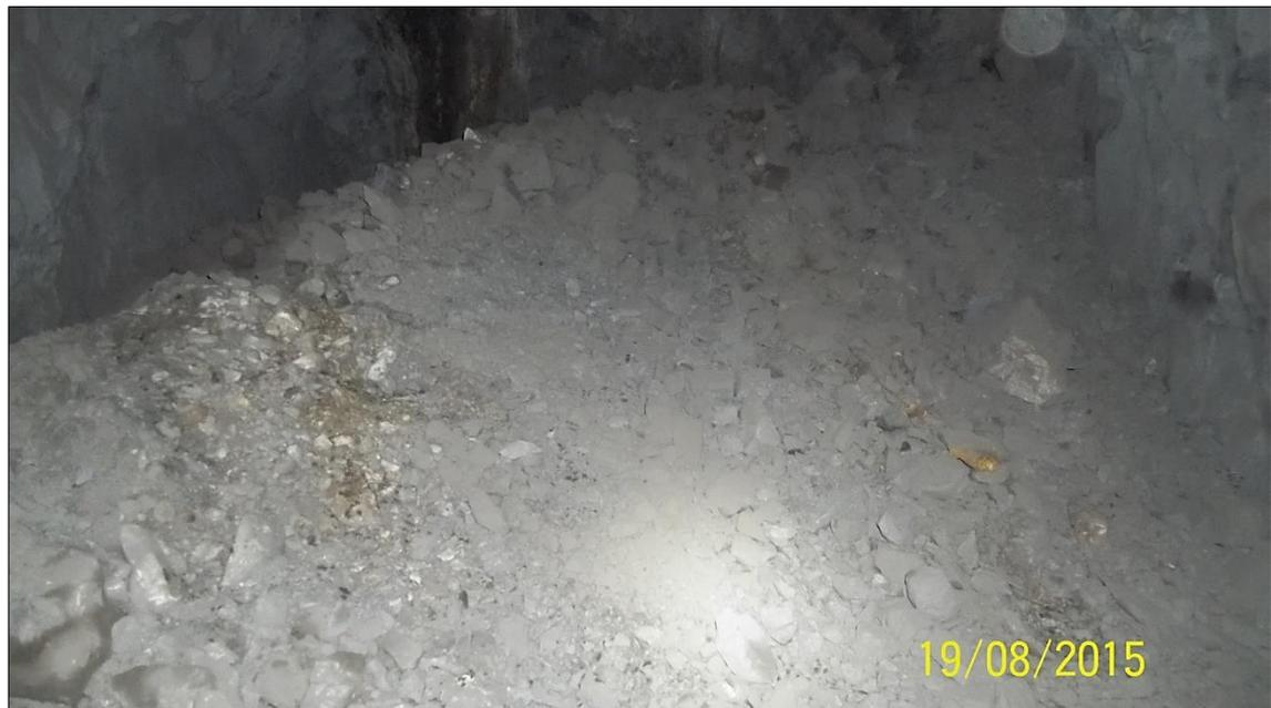
Imagen 32: fragmentación de la voladura - Prueba N° 3
