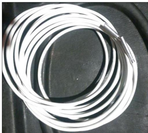
Imagen 6: Accesorio de voladura – Mecha de Seguridad (FAMESA explosivos)
