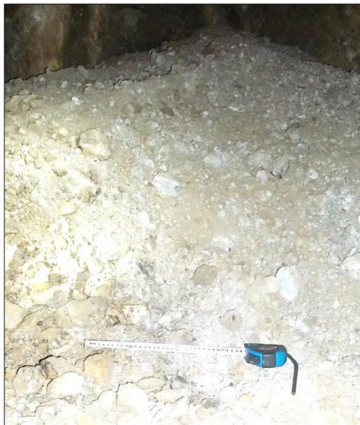
Imagen 10: Fragmentación de la voladura – Prueba N° 1
