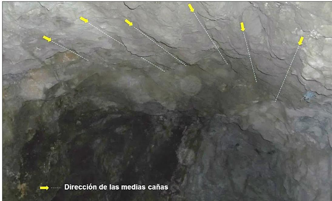
Imagen 18: Superficie con medias cañas y escaso material para tojeo – Prueba N° 5
