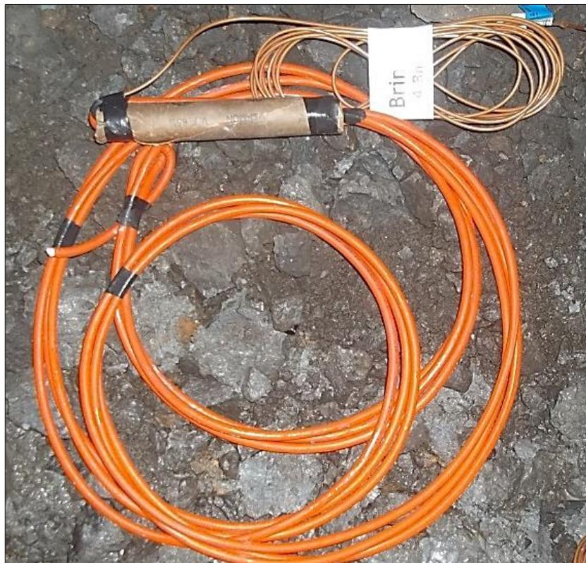
**Imagen 21:** Armado del cebo con triple cordón detonante – Prueba N° 7
