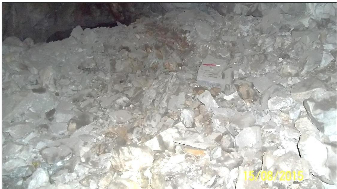
**Imagen 42:** fragmentación de la voladura - Prueba N° 7
