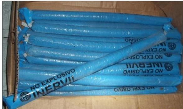
Imagen 8: Accesorio de voladura – Taco inerte Inervil (FM)
