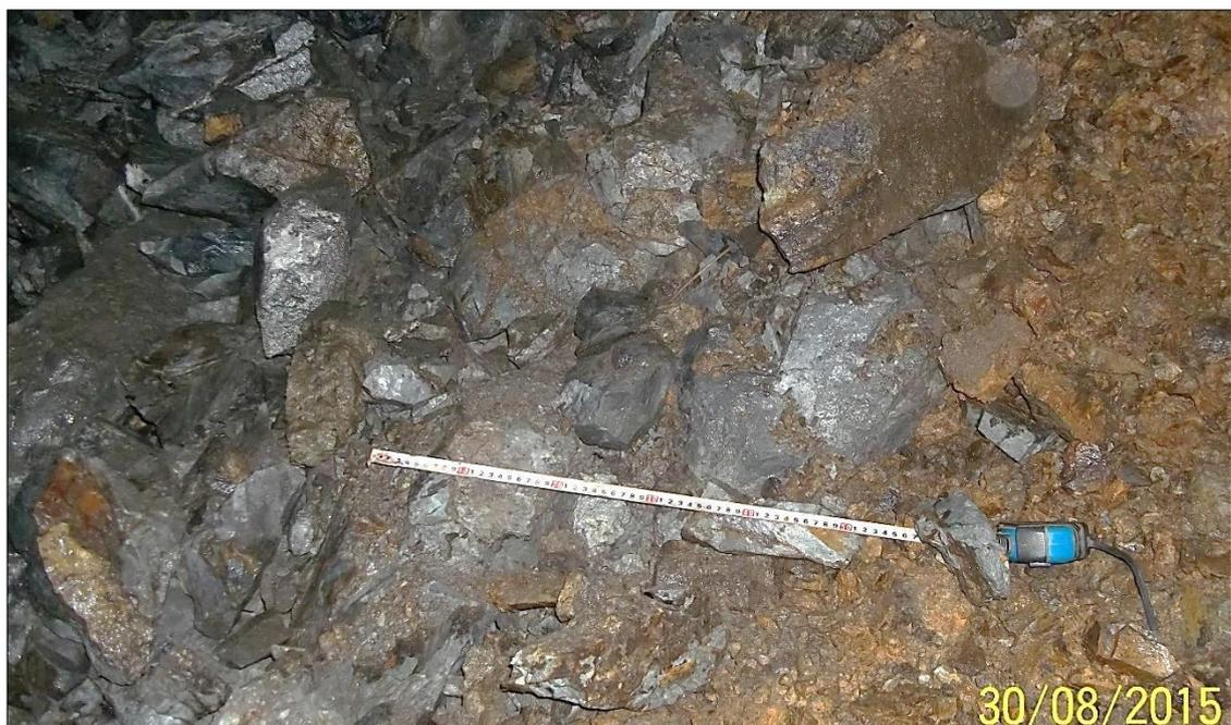
**Imagen 45:** fragmentación de la voladura - Prueba N° 8
