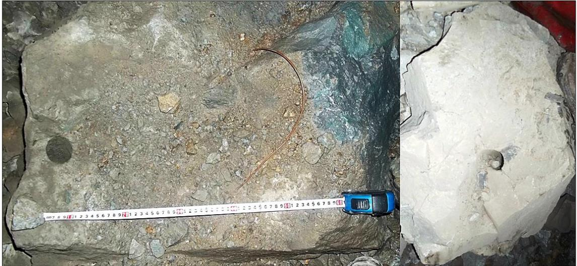
Imagen 13: Anillos de material producto de introducir demasiado en taco en el taladro – Prueba N° 2
