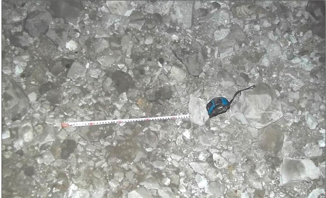
Imagen 26: Fragmentación de la voladura en mineral – Prueba N° 9
