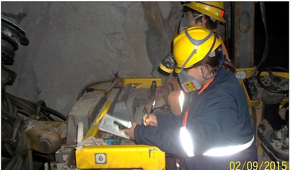
**Imagen 38:** control de los tiempos de perforación - Prueba N° 5
