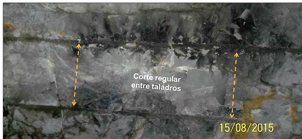
Imagen 23: Superficie precortada en el techo de la labor – Prueba N° 7
