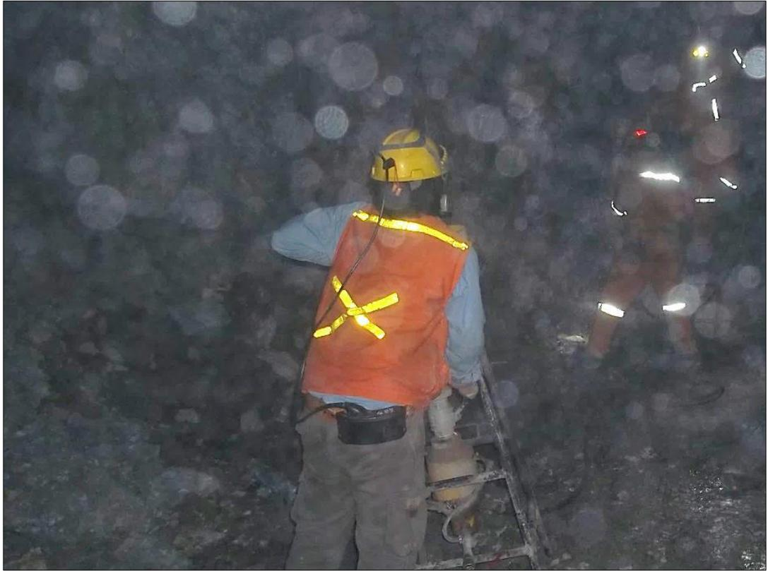
**Imagen 47:** utilizando cargadora de ANFO en tope - Prueba N° 9
