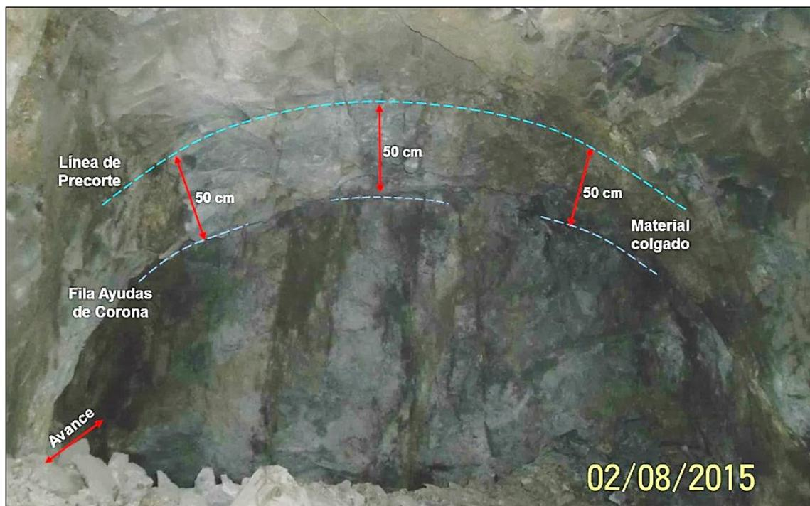
Imagen 11: Material colgado en el precorte – Prueba N° 2
