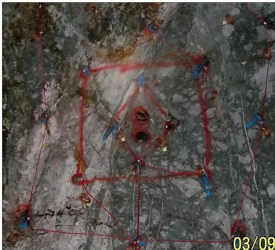
Imagen 36: arranque con dos taladros de expansión - Prueba N° 5
