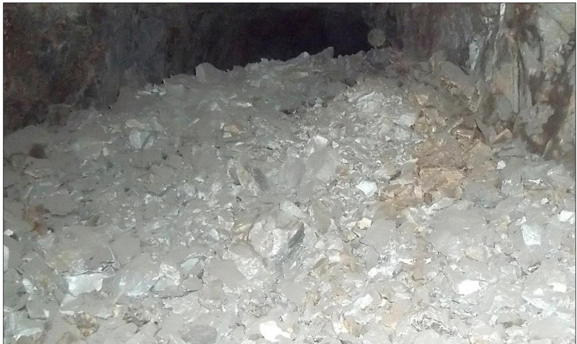
Imagen 39: fragmentación de la voladura - Prueba N° 6
