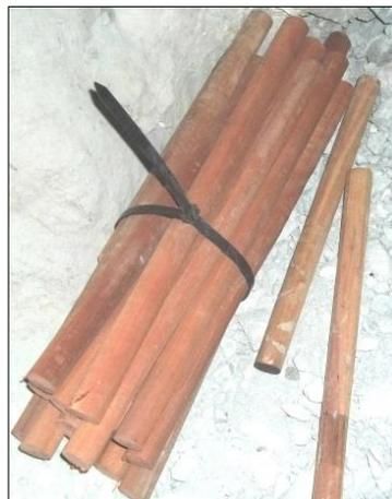
Imagen 9: Accesorio de voladura – Separadores de madera
