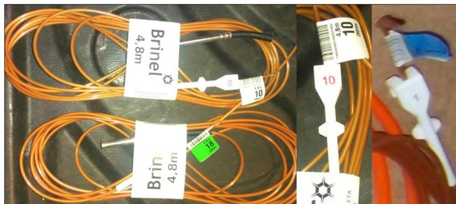
Imagen 7: Accesorio de voladura – Detonador no eléctrico con conector J (Britanite)
