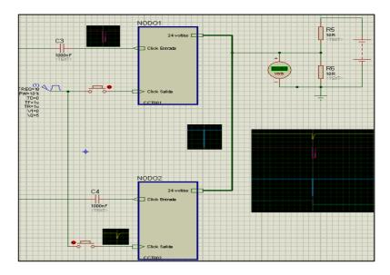
**Fig. 5:** Nodos de ensayo y señales encontradas (Azul: señal en el bus; Amarillo: señal generada; Rojo: señal detectada)
