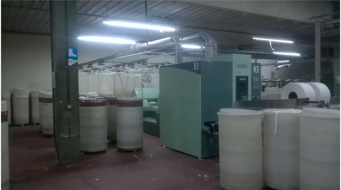
Figura 12.6 COTECA S.A. – Sector Unilap (unidora de cintas): en esta parte del proceso se unen cintas de manuales y se obtiene una napa que sirve de alimentación a las peinadoras.
