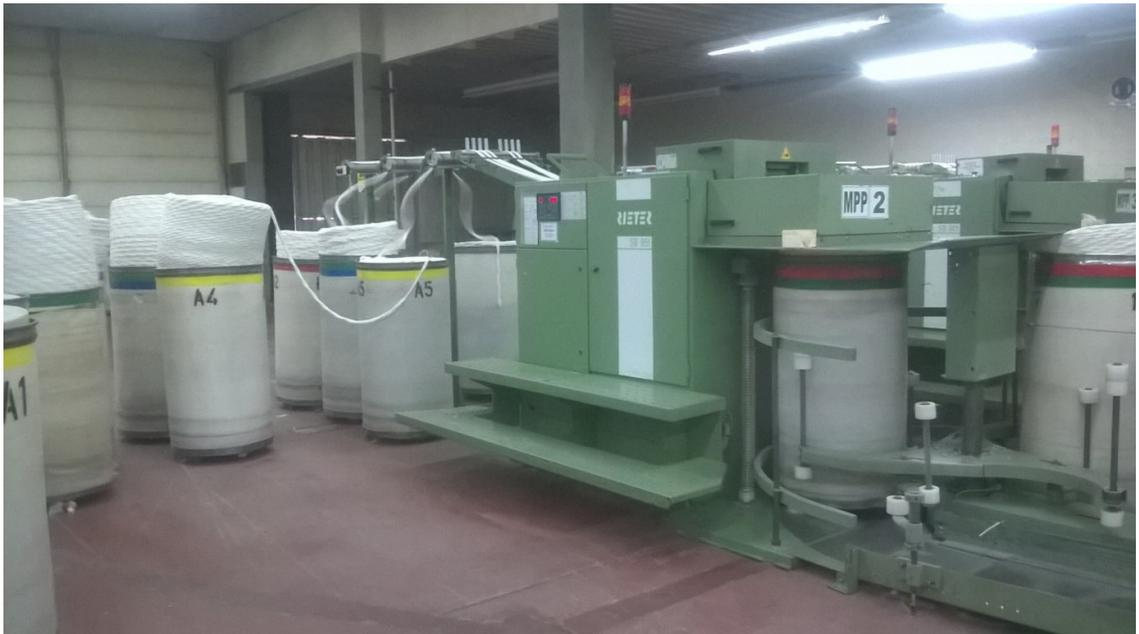
Figura 12.5 COTECA S.A. – Sector Manuales: en esta parte del proceso productivo se realiza la mezcla de cintas de carda y el estiraje necesario para obtener una cinta más fina.
