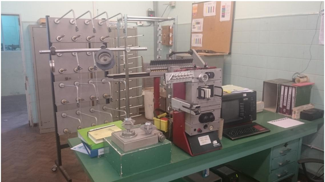
Figura 12.16 COTECA S.A. – Laboratorio de Control de Calidad: RegularímetroUster usado para medir parámetros de calidad del hilado.
