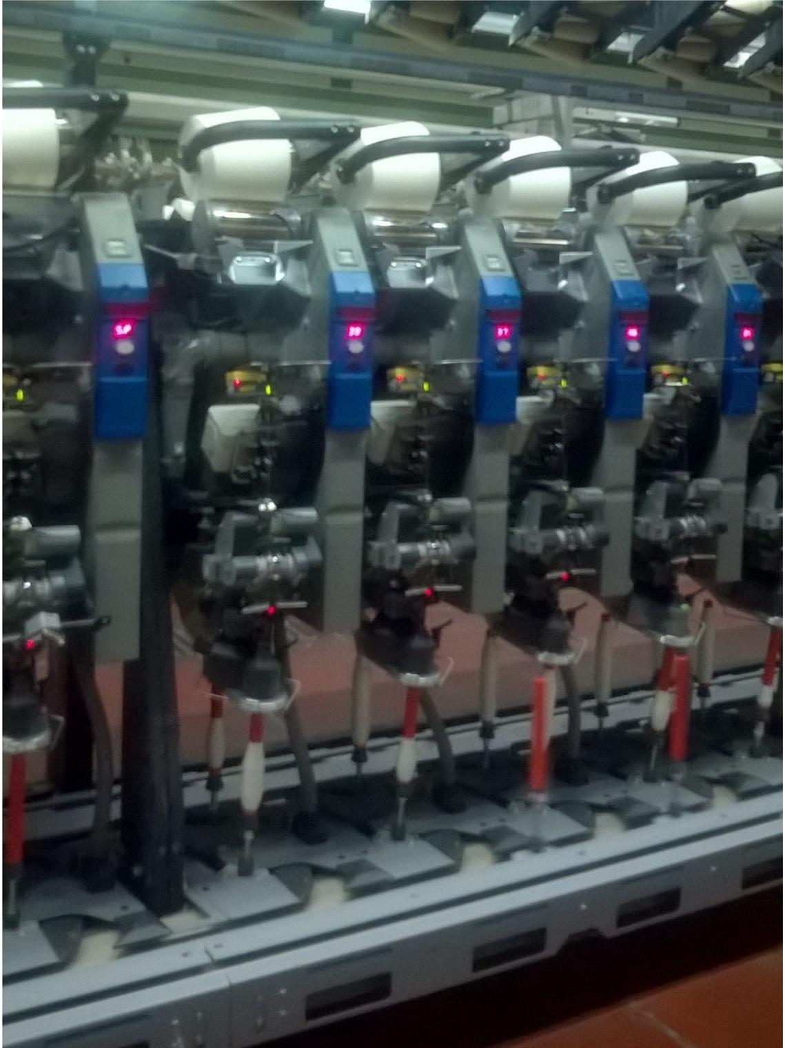
Figura 12.14 COTECA S.A. – Sector Enconadoras: es la parte final del proceso. Aquí se reúnen los *copsy* se van formando bobinas (conos) listo para su comercialización y envío a clientes.
