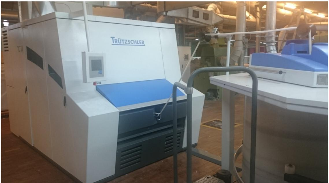
Figura 12.3 COTECA S.A. – Sector Cardas: vemos modelos de cardas más avanzados. Logran mayor limpieza a mayor velocidad.
