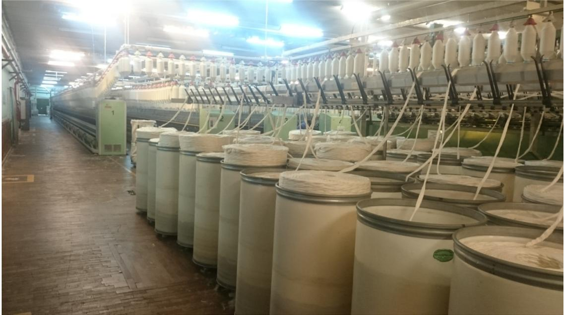
Figura 12.8 COTECA S.A. – Sector Mecheras (vista posterior): aquí se realiza el estiraje de la cinta peinada previo al proceso de hilatura propiamente dicho.
