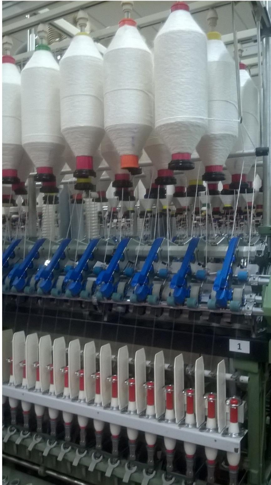
Figura 12.13 COTECA S.A. – Sector Continuas: vista detallada del puesto de hilatura. Pueden verse los *copsrojos* con el hilo obtenido. Los mismos luego serán reunidos y se formará una bobina.
