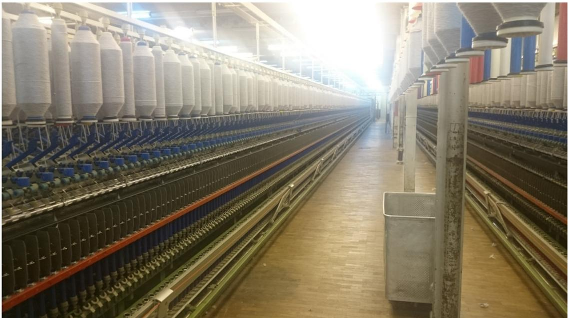
Figura 12.12 COTECA S.A. – Sector Continuas: en esta vista se puede apreciar la longitud de la máquina, que puede llegar a tener 1.800 puestos de hilatura.
