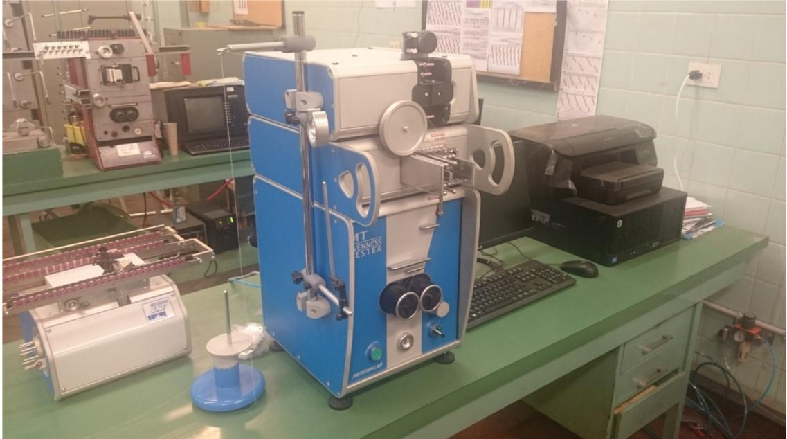
Figura 12.18 COTECA S.A. – Laboratorio de Control de Calidad: Regularímetro Mesdan usado para medir parámetros de calidad del hilado.
