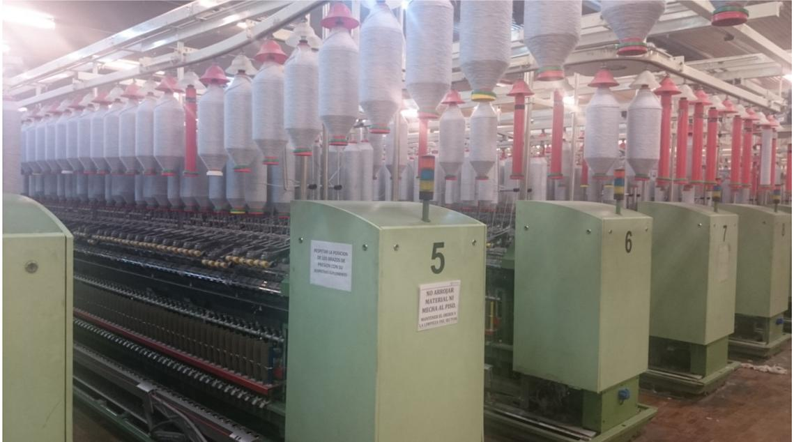
Figura 12.11 COTECA S.A. – Sector Continuas: en estas máquinas, llamadas *Continuas de Hilar*, se realiza la hilatura propiamente dicha, emulando el tradicional método de la rueca, se estira y da torsión a la mecha y se van obteniendo *cops* con hilo de las características deseadas.
