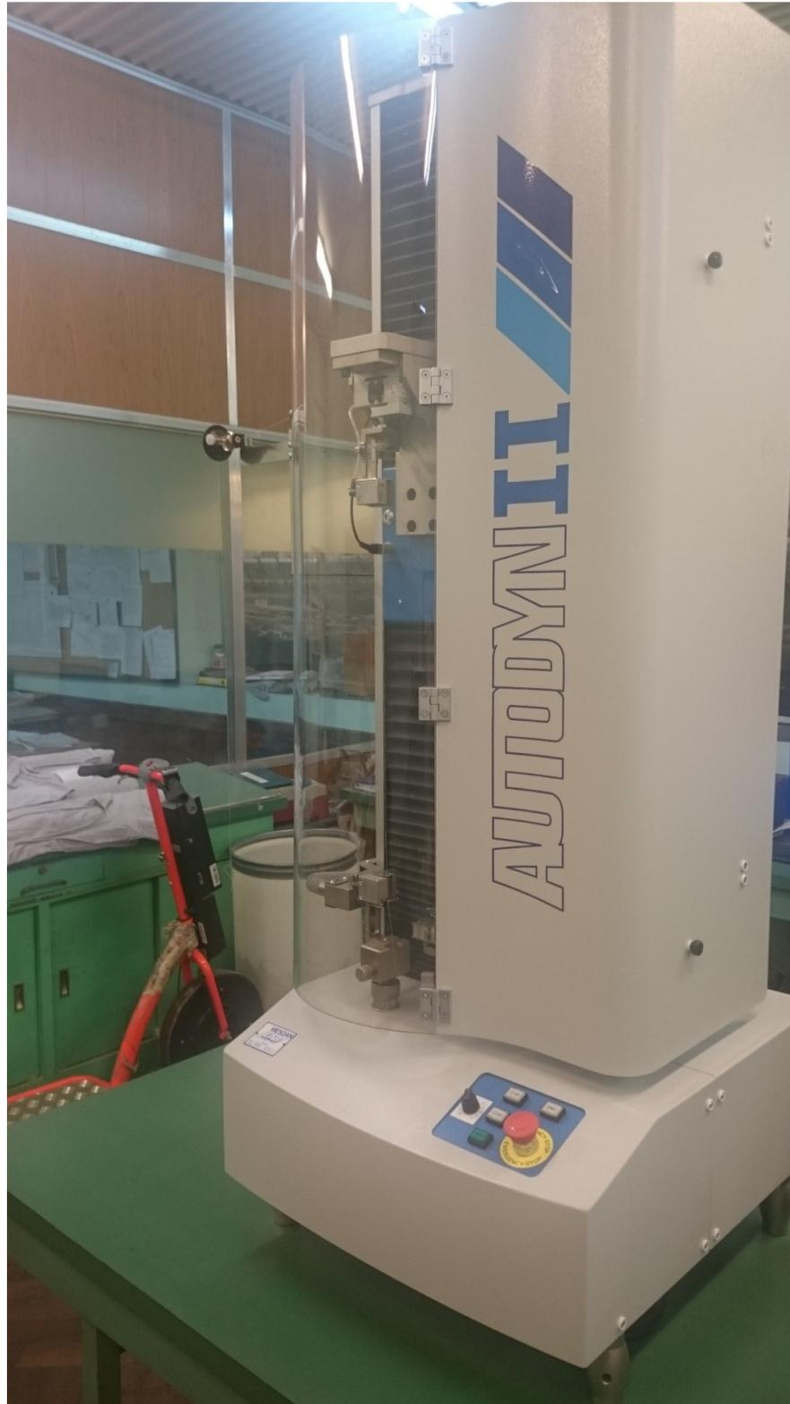
Figura 12.17 COTECA S.A. – Laboratorio de Control de Calidad: Dinamómetro Mesdan utilizado para medir la resistencia del hilado.
