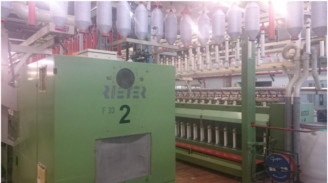
Figura 12.9 COTECA S.A. – Sector Mecheras (vista frontal): en la parte superior puede apreciarse la mecha obtenida en esta máquina.
