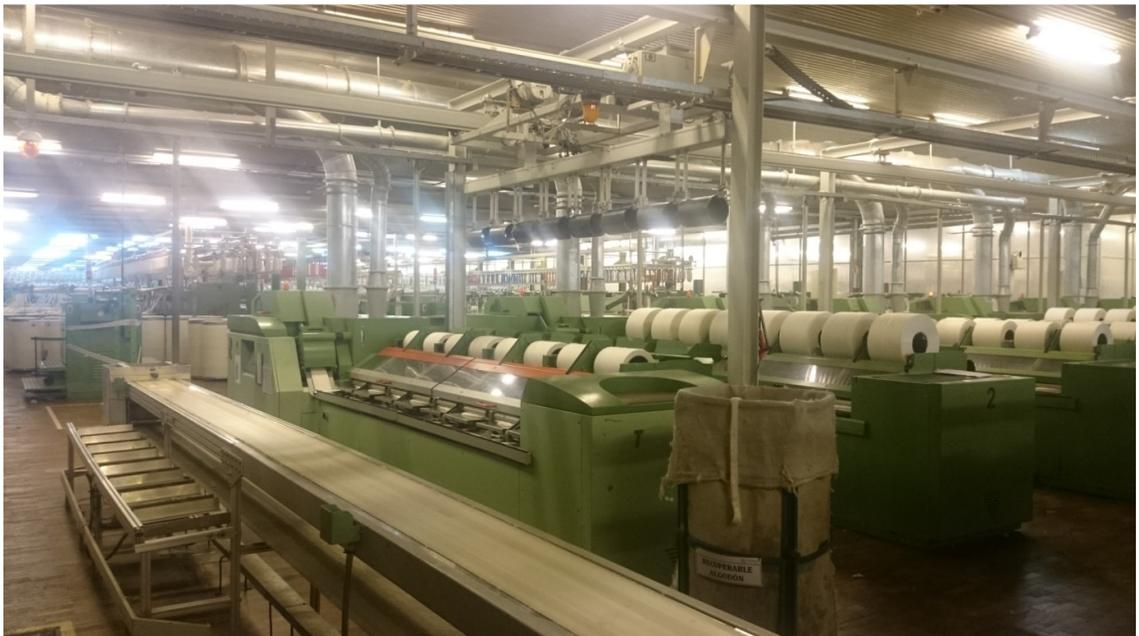
Figura 12.7 COTECA S.A. – Sector Peinadoras: en esta área se mezclan y peinan las napas, obteniendo así una cinta con un máximo nivel de limpieza y paralelismo de las fibras de algodón.
