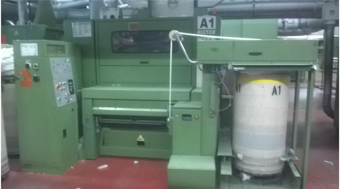
Figura 12.2 COTECA S.A. – Sector Cardas: aquí se ve la cinta de algodón obtenida luego del proceso de limpieza.
