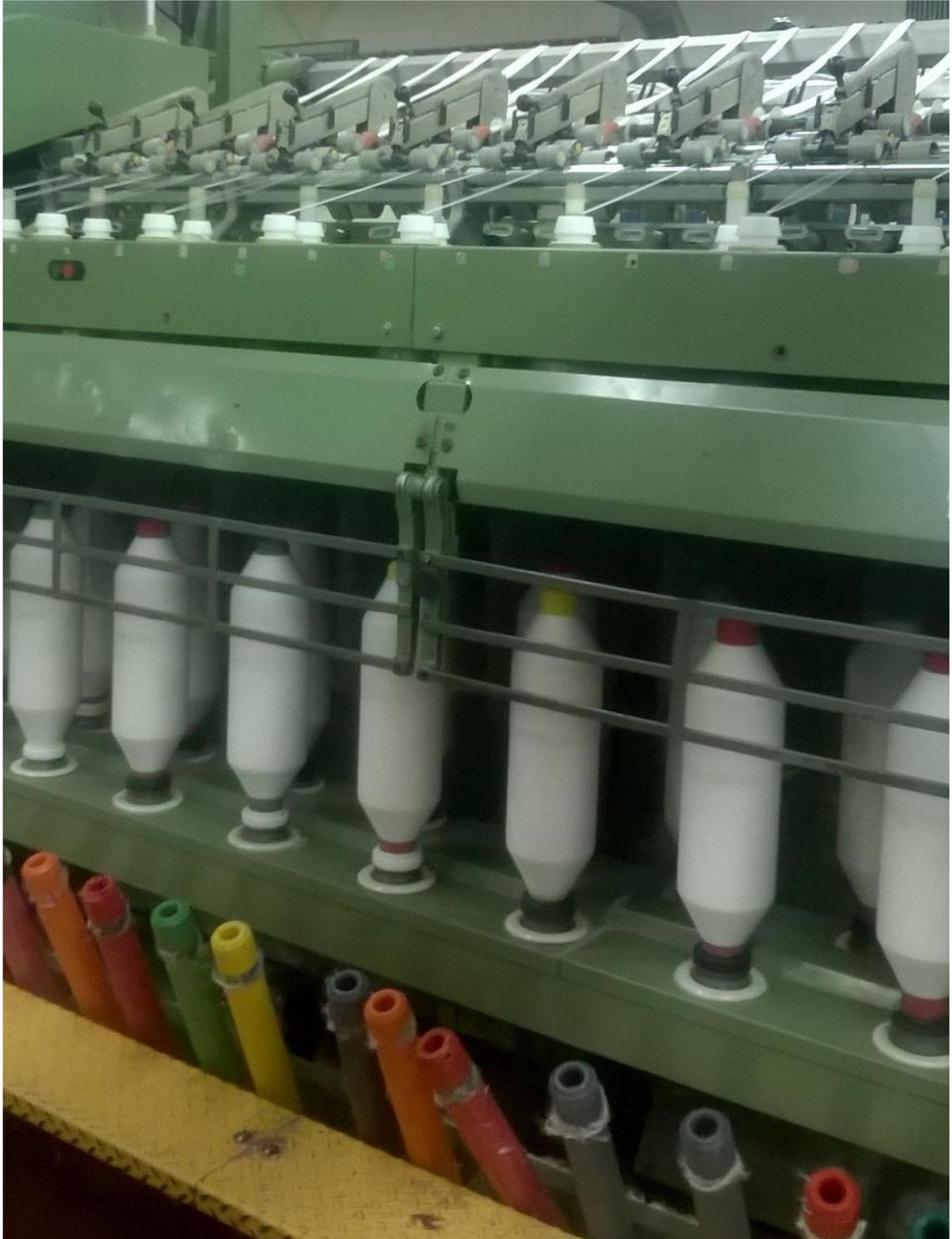
Figura 12.10 COTECA S.A. – Sector Mecheras (vista interior): proceso de formación de la mecha.
