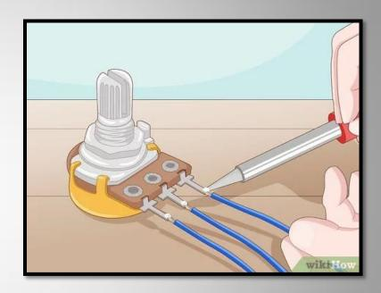
EL POTENCIÓMETRO SE CONECTA UNO DE LOS EXTREMOS (CUALQUIERA) AL POSITVO, EL OTRO EXTREMO AL NEGATIVO Y EL CONECTOR DEL MEDIO VA AL OSCILOSCOPIO. MOVIENDO LA PERILLA DEL OSCILOSCOPIO DE UN LADO AL OTRO, OBSERVAMOS AHORA EN EL OSCILOSCOPIO QUE LA SEÑAL YA NO TOMA DOS ESTADOS (TODO O NADA) AHORA TIENE UNA FORMA DE CURVAS QUE SUBEN Y BAJAN (SEÑAL SENOIDAL).
