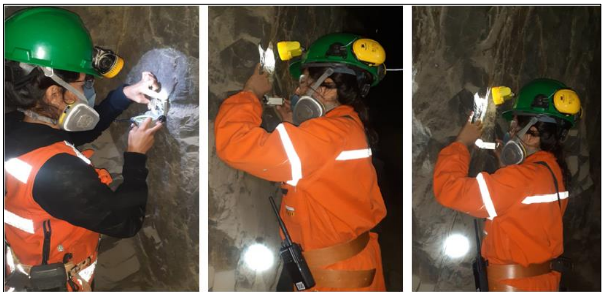
Ilustración 92: Toma de datos de Buzamiento y Dirección de Buzamiento en campo
