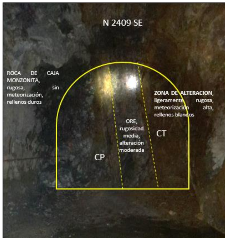
Ilustración 52: Condiciones del frente de perforación N2409 SE
